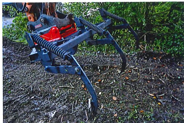
Der selbstgebaute Reisigrechen ist 1,95 Meter breit und besitzt drei federnde Zinken. Fotos Biernath
