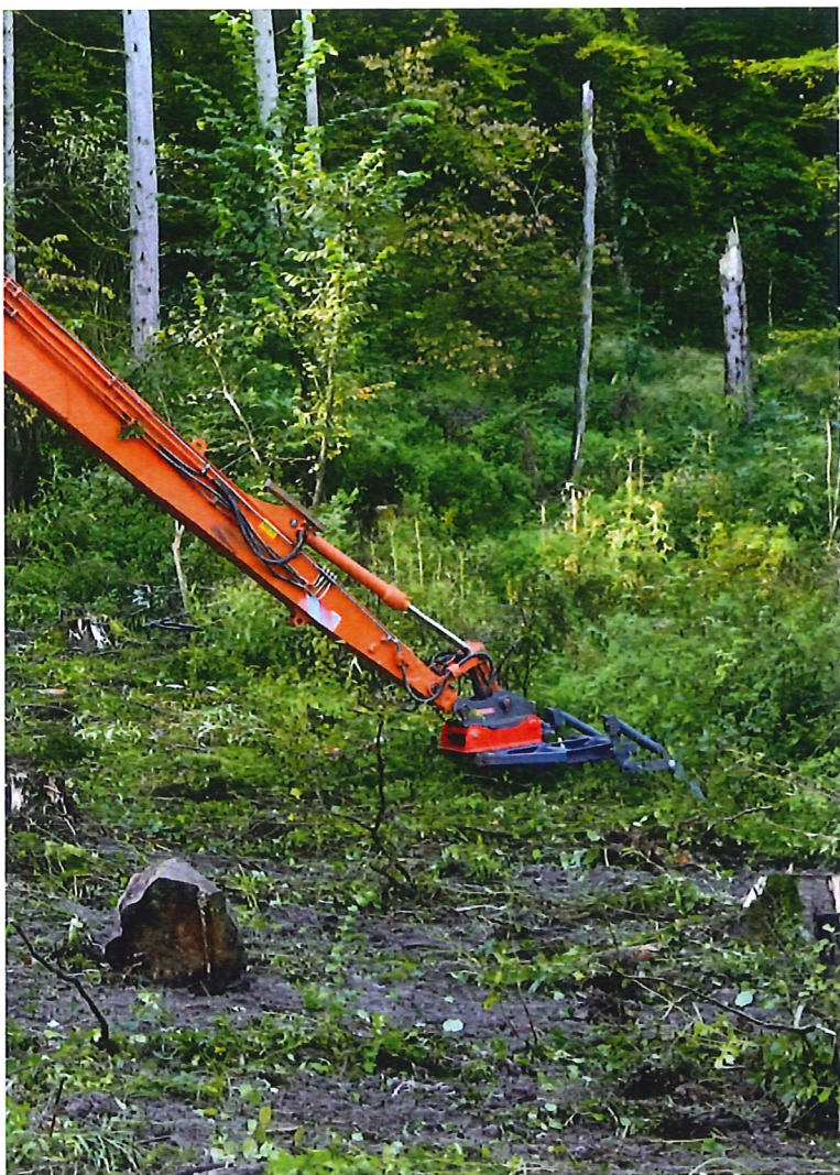
Der selbstgebaute Reisigrechen ist 1,95 Meter breit und besitzt drei federnde Zinken. Fotos Biernath
