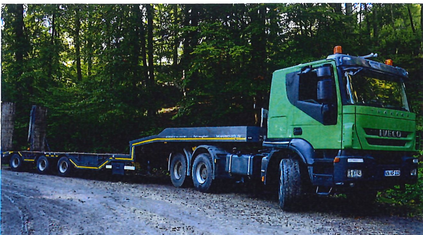
Bagger und Raupen werden mit dem Sattel-Tieflader von Möslein transportiert.
