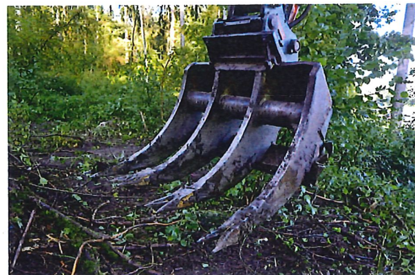
Der Reisigrechen kann schnell gegen eine Stubbengabel getauscht werden. Auch ein Grabenlöffel ist vorhanden.
